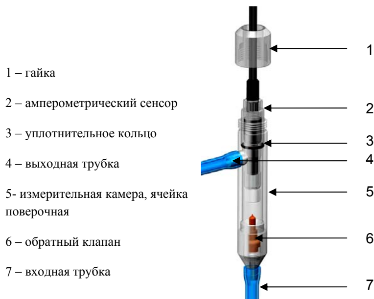
Рис. 1. Внешний вид измерительных камер ИКПГ, ИКПЖ и ячейки поверочной.
