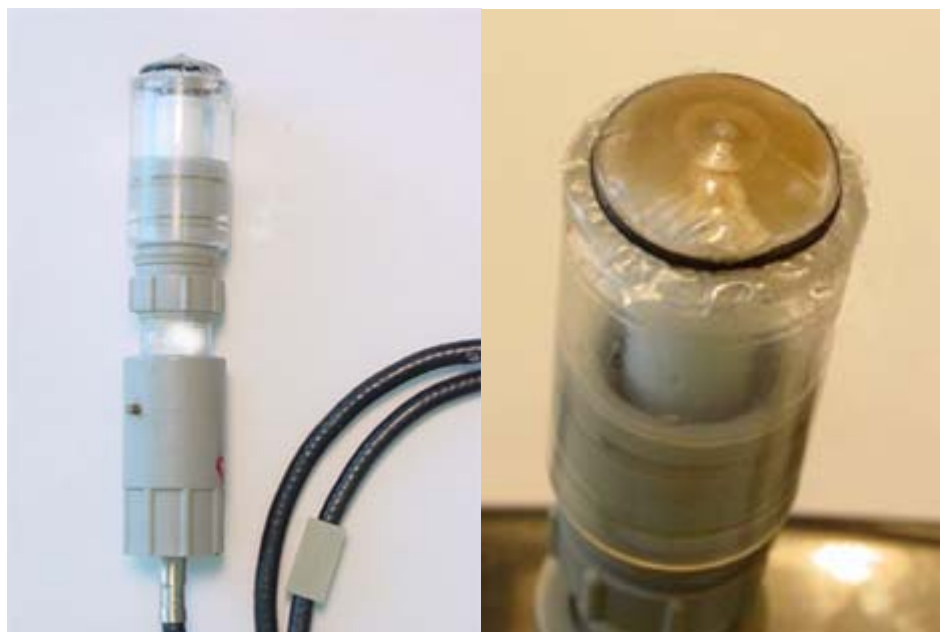
Рис.4 Внешний вид микробиологического биосенсора МББ-01.
