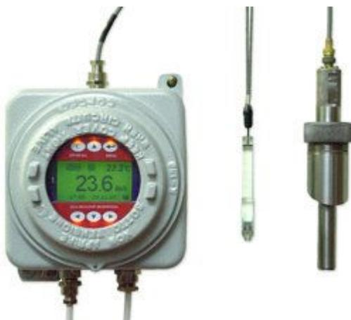
Промышленные водородомеры марки АВП могут выпускаться во взрывозащищенном исполнении по ГОСТР30852.0, ГОСТР30852.1, ГОСТР30852.10 с уровнем взрывозащиты «взрывобезопасный» для взрывоопасных смесей газов и паров с воздухом категории IIC температурной группы Т6. Анализаторы во взрывозащищенном исполнении имеют маркировку взрывозащиты 1Exd[ib]IICТ6 X и предназначены для применения во взрывоопасных зонах согласно ГОСТР30852.9, ГОСТР30852.13.
