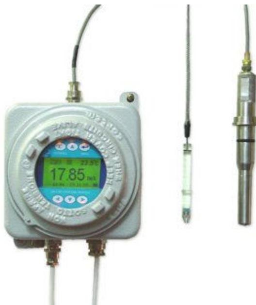
Промышленные кислородомеры марки АКПМ могут выпускаться во взрывозащищенном исполнении по ГОСТР30852.0, ГОСТР30852.1, ГОСТР30852.10 с уровнем взрывозащиты «взрывобезопасный» для взрывоопасных смесей газов и паров с воздухом категории IIC температурной группы Т6. Анализаторы во взрывозащищенном исполнении имеют маркировку взрывозащиты 1Exd[ib]IICТ6 X и предназначены для применения во взрывоопасных зонах согласно ГОСТР30852.9, ГОСТР30852.13.
