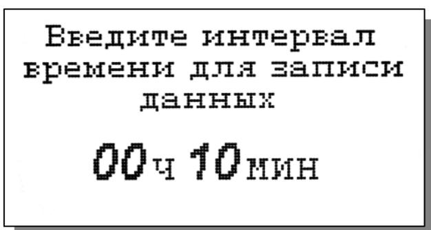
При выборе опции задания интервала с помощью клавиш перемещения курсора введите интервал времени записи результатов измерений и нажмите клавишу «ВВОД» (рис. 2.3.5-1).
