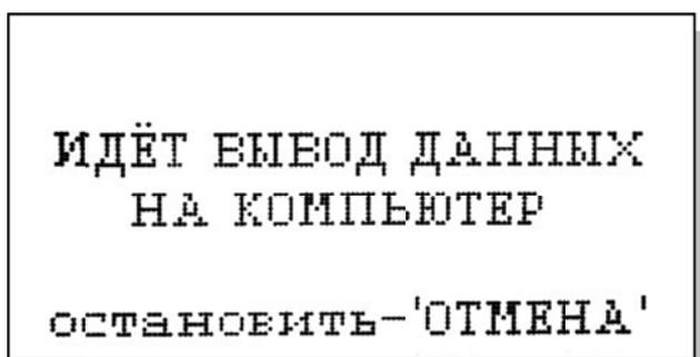
При выборе опции «Вывод данных на компьютер» осуществляется передача протокола данных на компьютер по каналу RS-485 (рис. 2.3.5-5). При этом на дисплее появится информация о выводе данных.
