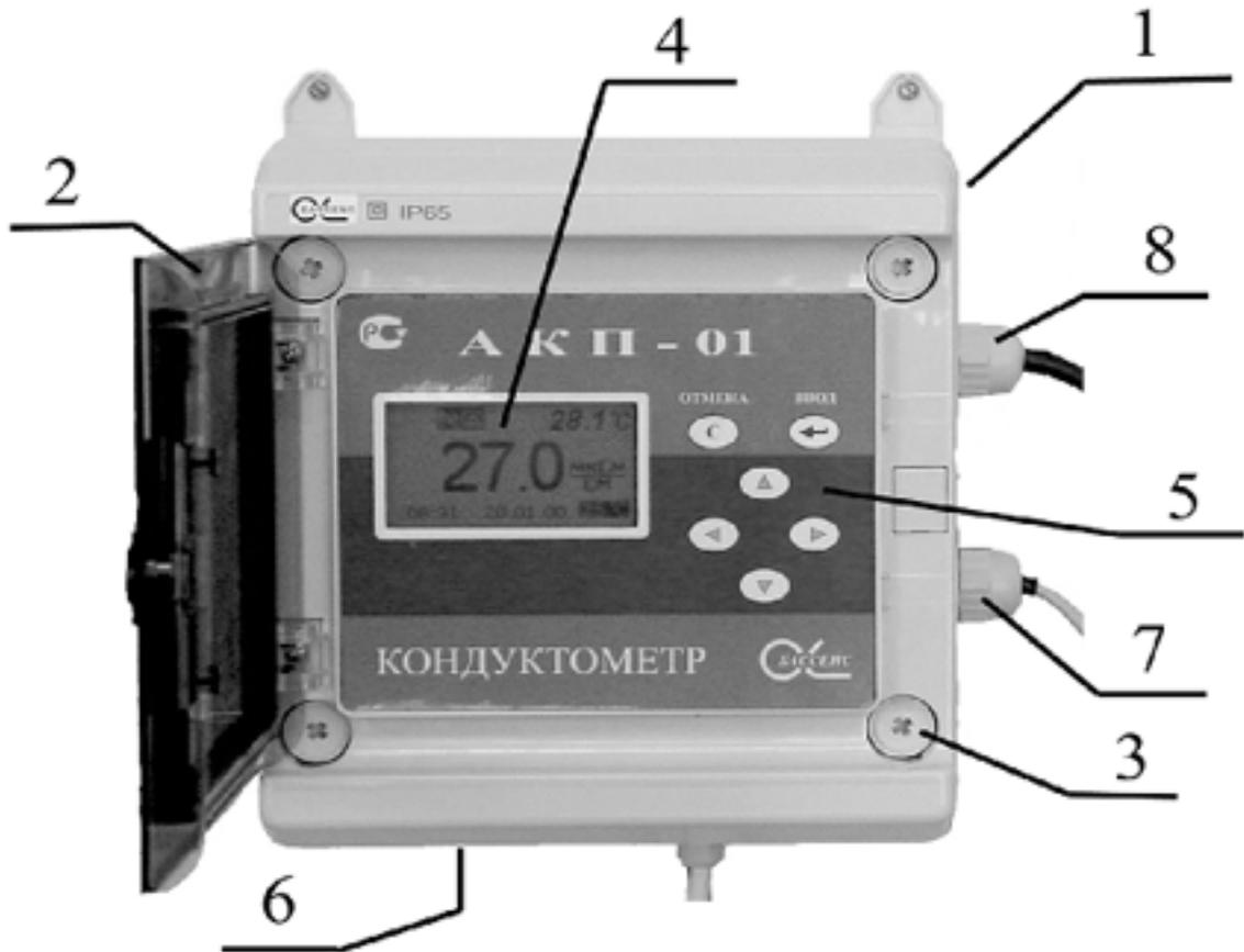
Рис. 1.4-2 Измерительное устройство анализатора АКП-01.
