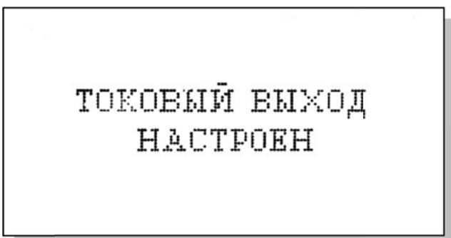
После нажатия клавиши «ВВОД» на дисплее анализатора высветится надпись «ТОКОВЫЙ ВЫХОД НАСТРОЕН», после чего анализатор перейдет в режим измерений и на дисплее высветится окно, показанное на рис. 2.3.1-1.
