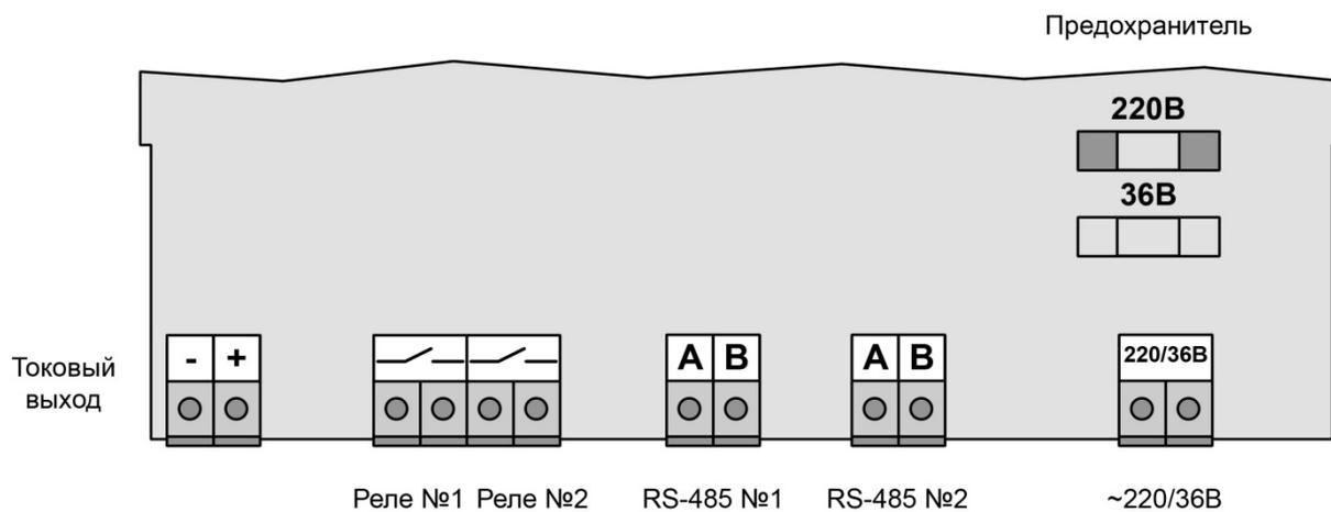
Рис.2.2.1-3 Подключение внешних проводов и кабелей
