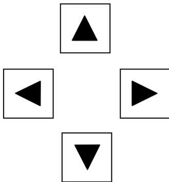
В режиме «Измерение» при нажатии клавиши «ВНИЗ» осуществляется запись данных в электронный блокнот, а при нажатии клавиши «ВЛЕВО» включается/выключается режим приведения результатов измерений к температуре 25°C или 20°C. При этом на дисплее появляется/исчезает иконка 25°C или 20°C.
