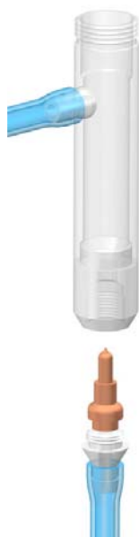
Рис. 4.5. Установка обратного клапана в ИКПЖ
