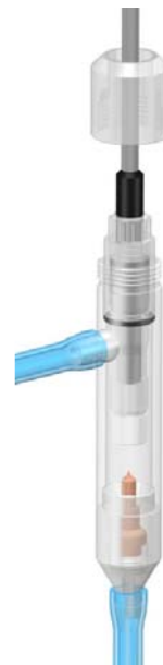
Рис. 3.10. Фиксация АСрН 2 в измерительной камере
