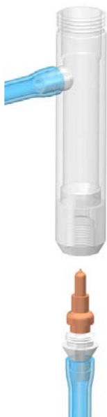
Рис. 4.5. Обратный клапан в ИКПЖ
