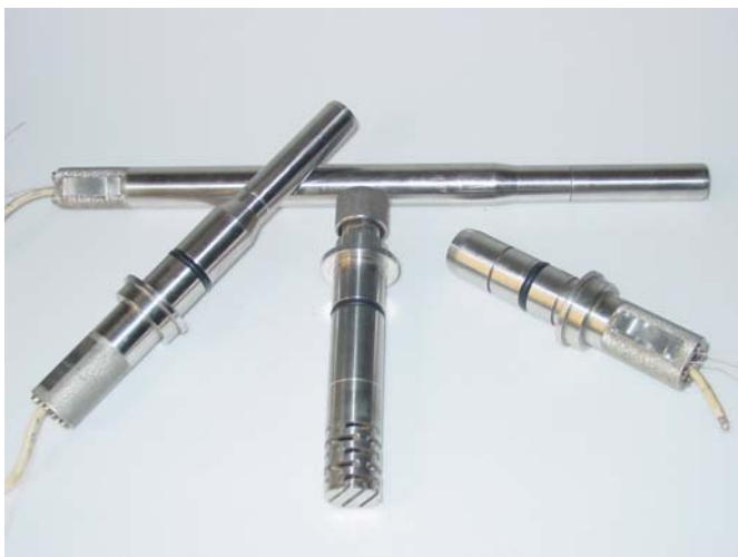
Рис. 3.6. Внешний вид стерилизуемых амперометрических сенсоров АСрН 2 -06.
