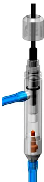
Рис. 3.6. Установка АСрН 2 в измерительную камеру.
