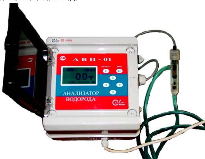
Рис. 2.3. Внешний вид анализатора АВП-01Г
