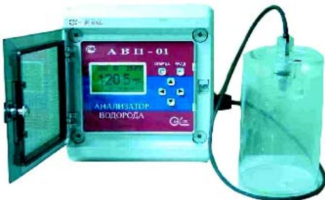
АВП-01Л в комплекте с АСрН<sub>2</sub>-01 предназначен для измерений концентрации, парциального давления водорода и температуры в жидкостях и газах. Применяется в лабораторных условиях различных промышленных предприятий и научно-
