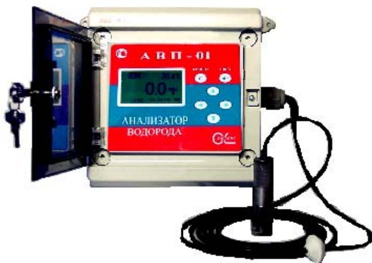
Рис. 2.4. Внешний вид анализатора АВП-01П
