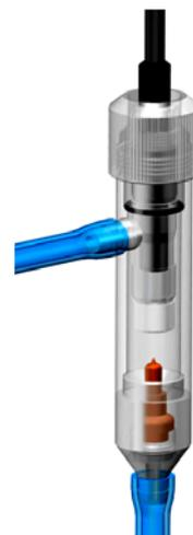
Рис. 3.10. Фиксация ACSrH<sub>2</sub> в измерительной камере.
