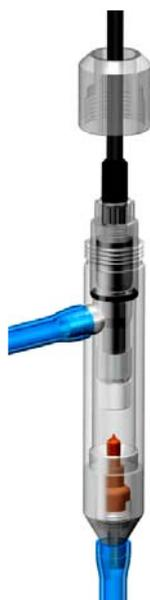
Рис. 3.9. Установка ACSrH<sub>2</sub> в измерительную камеру.
