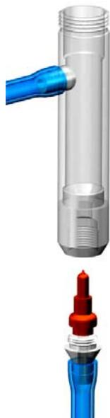
Рис. 4.5. Установка обратного клапана в ИКПЖ
