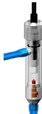
Рис. 3.2. Внешний вид сенсора в измерительной камере.
