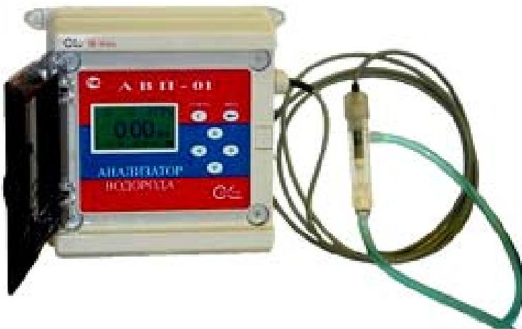
Анализатор АВП-01Г (см. рис. 2.2) в комплекте с АСрН<sub>2</sub>-03 предназначен для измерений концентрации водорода в газообразных средах. В тех случаях, когда анализируемый газ находится под разряжением и высоких температурах, анализатор
