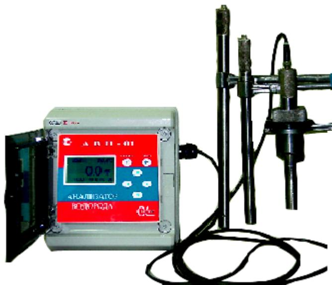
Рис. 2.5 Внешний вид анализатора АВП-01А
