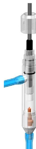
Рис. 3.9. Установка АСрН 2 в измерительную камеру
