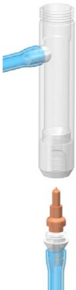
Рис. 4.5. Установка обратного клапана в ИКПЖ
