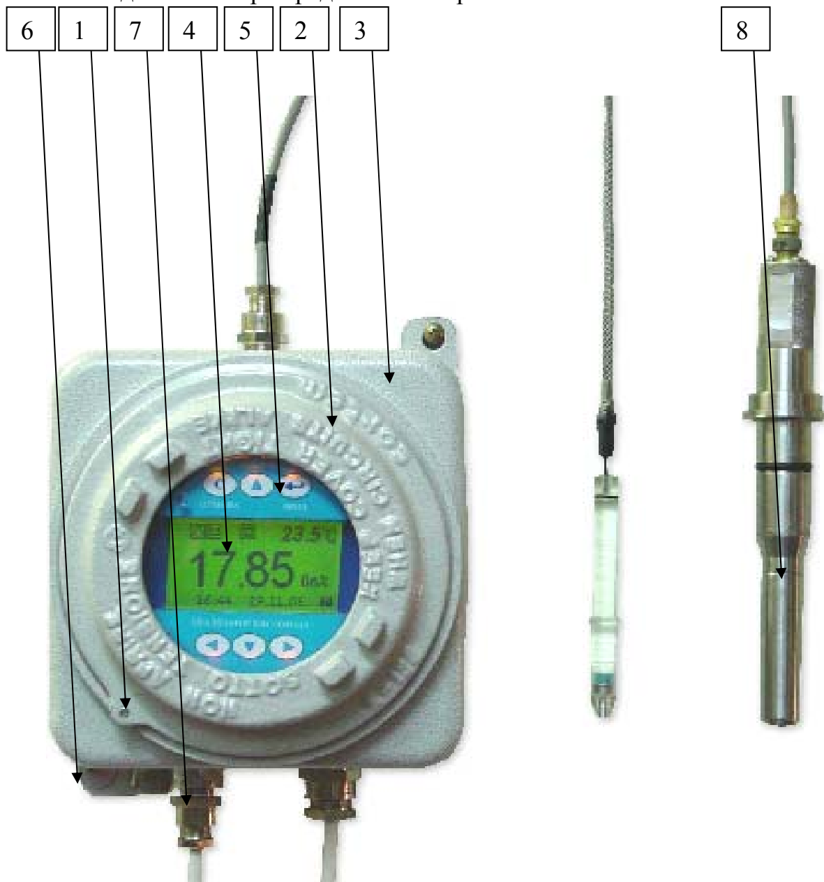
Рис. 4.1. Внешний вид анализатора кислорода АКПМ-1-11.
