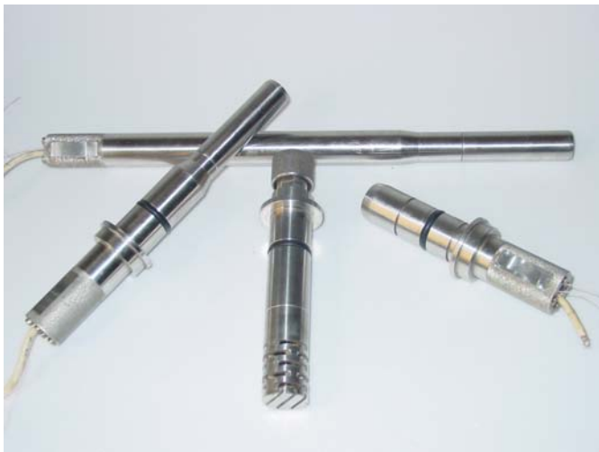
Рис. 3.6. Внешний вид стерилизуемых амперометрических сенсоров \text{АСрО}_2\text{-06} .
