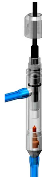
Рис. 3.10. Фиксация ASrO_2 в измерительной камере
