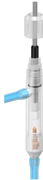
Рис. 3.10. Фиксация АСрО 2 в измерительной камере
