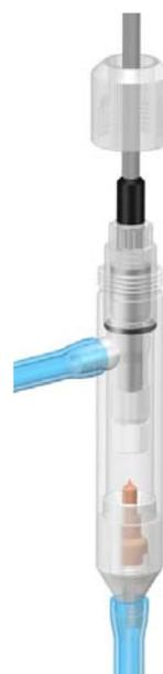
Рис. 2.1.2. Фиксация  $ASrO_2$  в измерительной камере.
