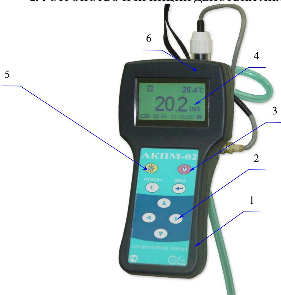
Рис. 2.1. Внешний вид анализатора кислорода АКПМ-1-02 (лицевая сторона).
