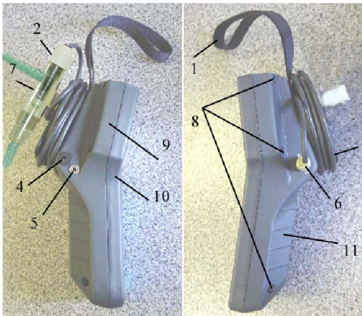
Рис. 2.1-1. Внешний вид анализатора кислорода АКПМ-1-02 (боковые стороны).
