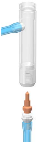
Рис. 4.5. Установка обратного клапана в ИКПЖ
